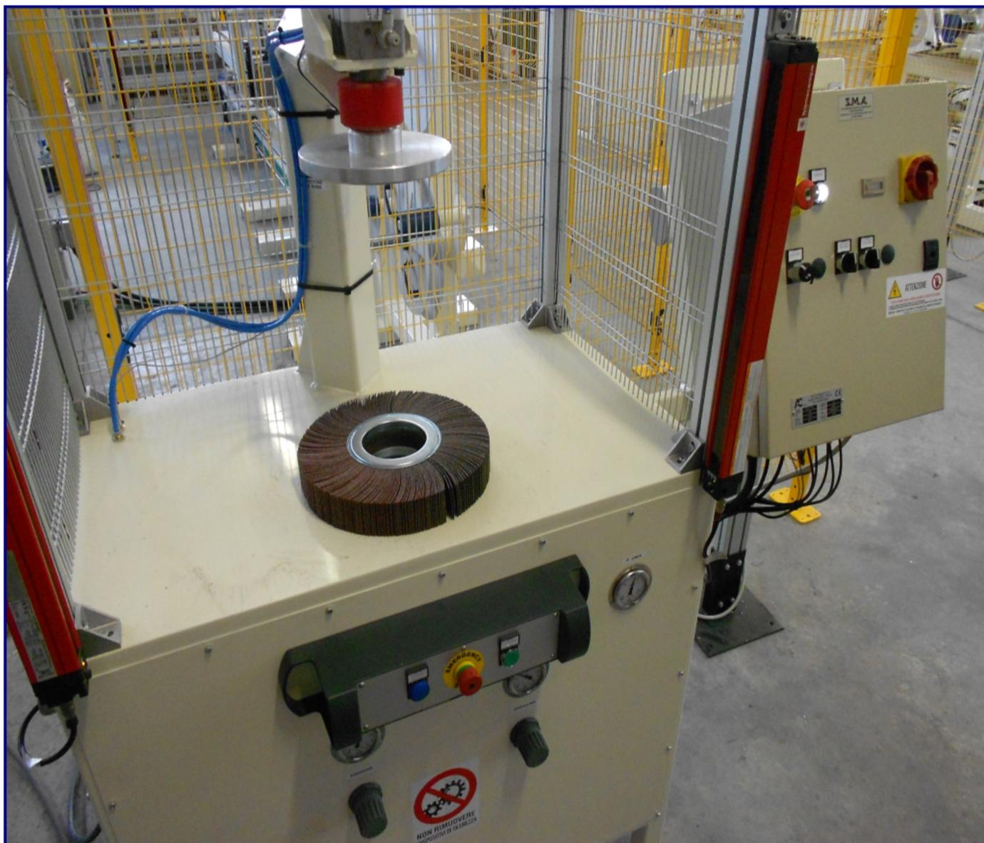
Impianto con ciclo di lavoro automatico per la pressatura delle ruote in tela con flangia.
